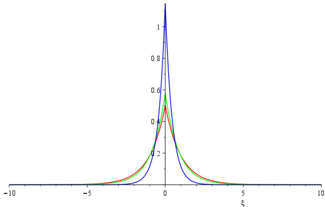
Нагрузка, движущаяся с постоянной докритической скоростью: профиль прогиба
